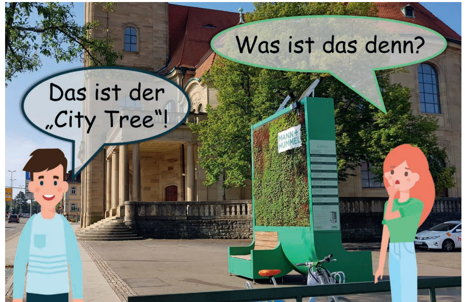
Abb. 2-2: Lea und Ben vor dem sog. „City Tree“, einer Mooswand, die als vertikaler Luftfilter Luftschadstoffe binden und das Kleinklima verbessern soll (aus dem Bound „Grün in der Stadt“).
